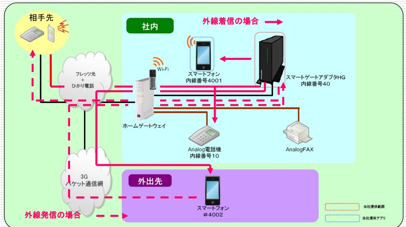
スマートフォンは社内ではWi-Fiで内線電話として、社外では3G(4G)パケットデータ通信網経由で内線電話として使えます。
